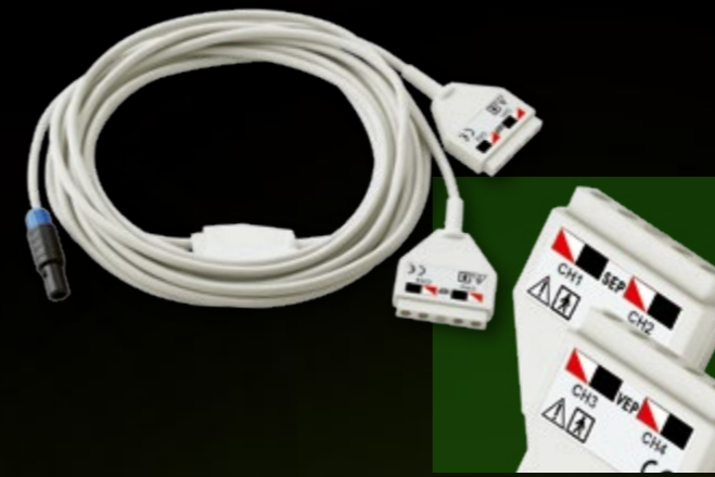
41-1000 Stimulationskabel für AVALANCHE® PLUS I/O-Box zum Anschluss von Stimulationssonden und -elektroden mit Steckern nach DIN 42802-1 (Output A1-2) und VEP-Blitzbrillen mit Steckern nach DIN 42802-1 (Output A3-4), Kabellänge 4 m, Stecker blau/schwarz, nicht autoklavierbar
