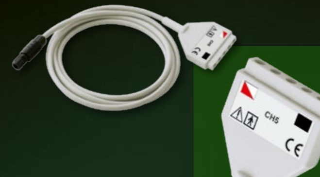
41-0083 Stimulationskabel für TWISTER® MM 1-Kanal, Output 5-6, zum Anschluss von Stimulationssonden und -elektroden, mit Steckern nach DIN 42802-1, Kabellänge 4 m, Stecker schwarz/schwarz, nicht autoklavierbar
